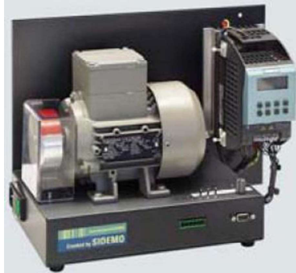
Resim 2.2: AC motor hız kontrol uygulaması
