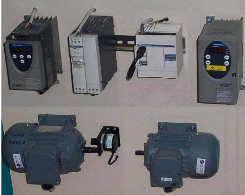
Resim 2.4: AC motor hız kontrol uygulaması
