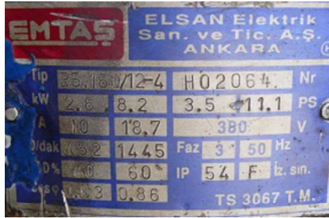
Resim 1.4: Farklı kutup sayılı iki sargısı bulunan asenkron motorun etiket deęerleri
