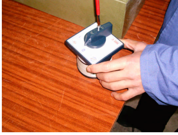
Resim 1.4: Şalterin kolunun sökülmesi
