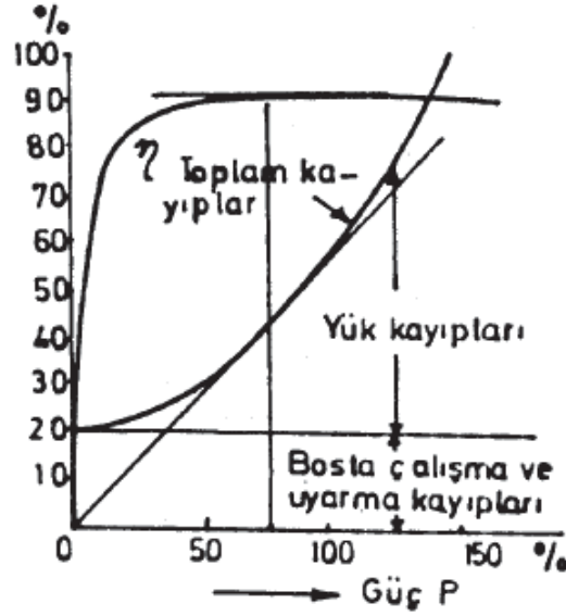
Doğru akım makinasının yüke bağlı kayıp ve verim eğrileri
