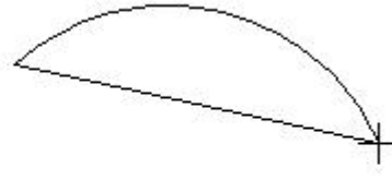
Merkezi, Başlangıç Noktası ve Kiriş uzunluğu bilinen yay
