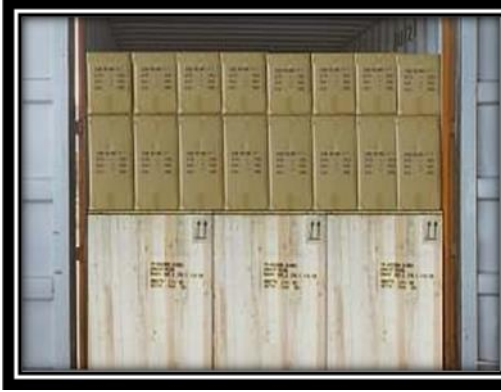
Resim 2.51: Doğru yükleme örneği
