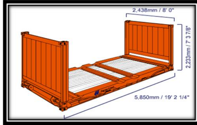
Resim 2.26: 20 feet düz (flat) konteyner
