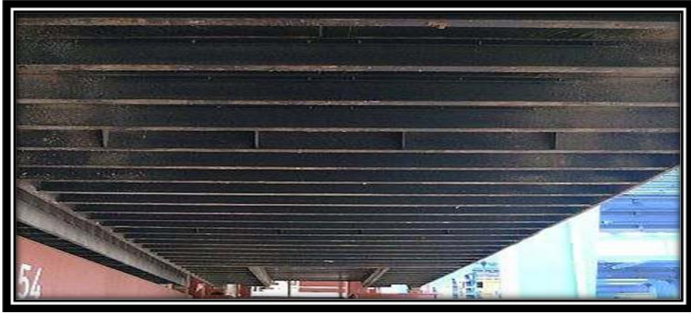
Resim 2.7: Konteyner taban döşemesi ve profili
