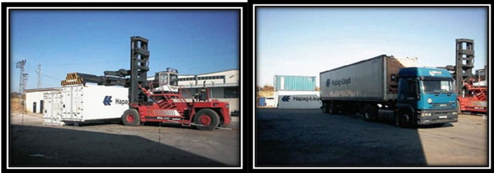
Resim 2.35: Soğutmalı konteynerin yüklenmesi ve taşınması
