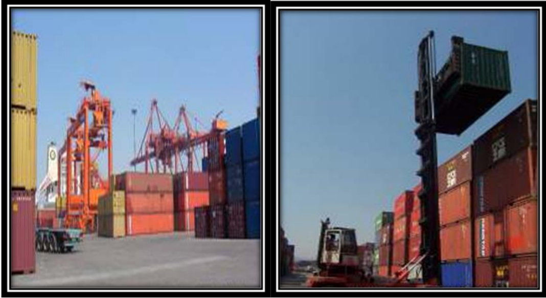
Resim 2.67: Köşe direkleri üst üste gelerek istiflenmiş konteynerler
