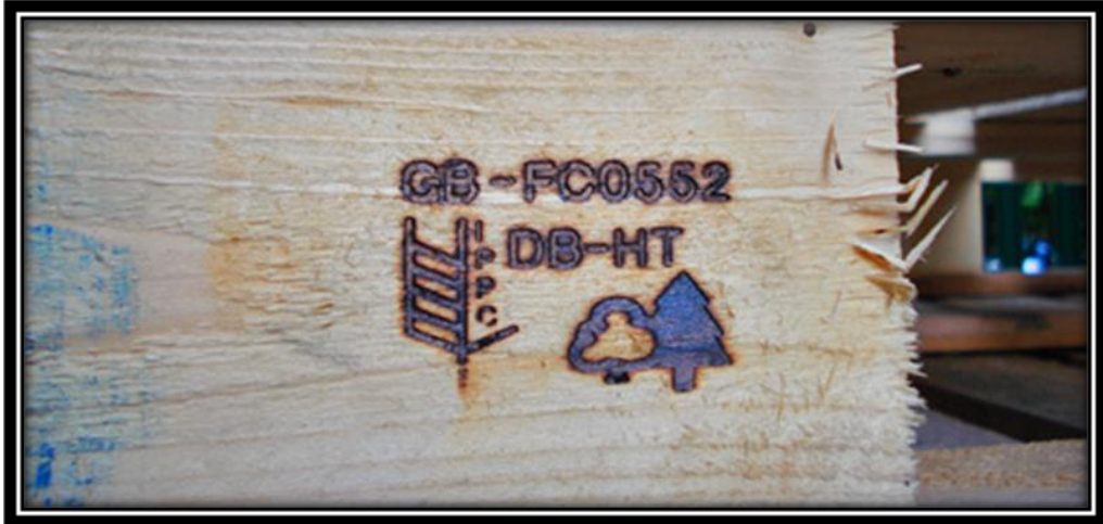
Resim 1.17: Palet üzerinde EPAL damgası
