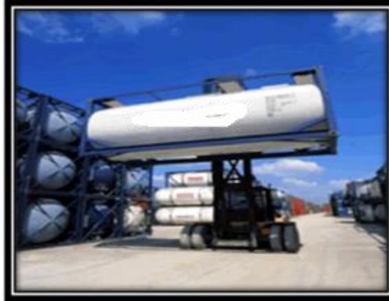
Resim 2.46: Sıvı dökme yük konteyneri (tank)
