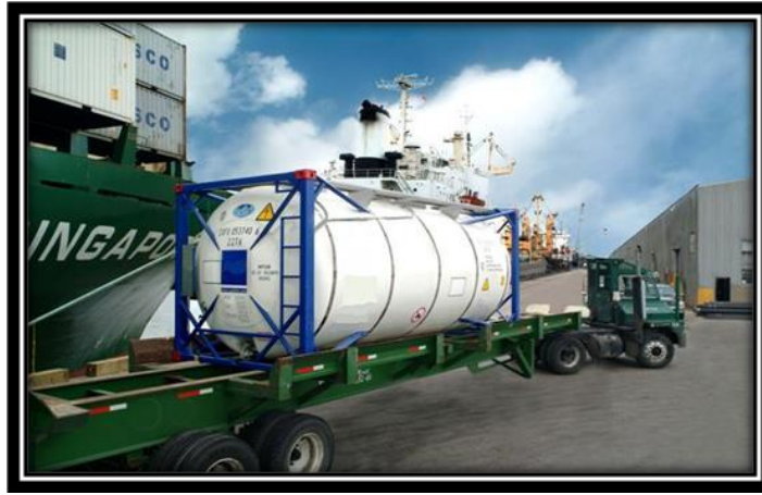
Resim 2.39: Tank konteynerin nakliyesi
