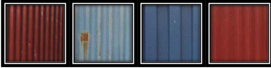
Resim 2.11: Konteyner duvarında kullanılan oluklu sac örnekleri
