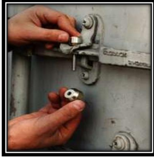
Resim 2.66: Konteyner kapı mühürleme
