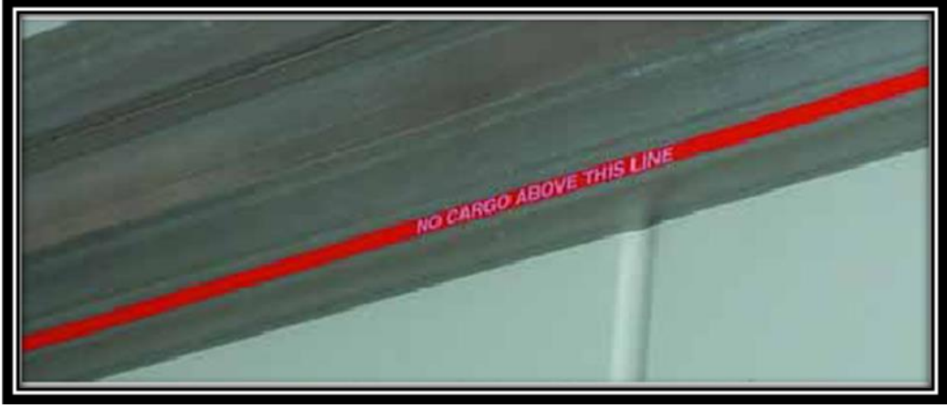
Resim 2.56: Konteyner yükleme sınır çizgisi
