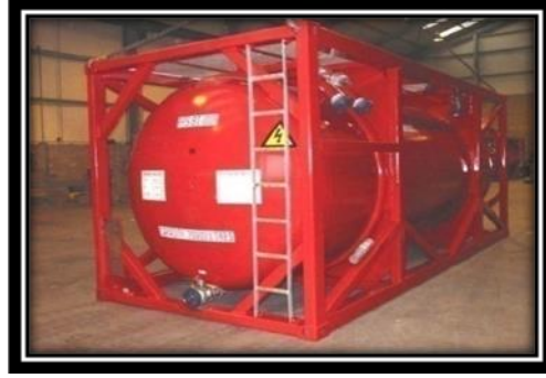
Resim 2.38: 20 feet tank konteyner
