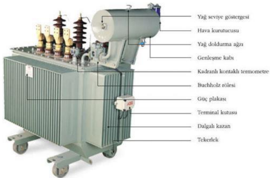
Genleşme depolu yağlı tip dağıtım trafosunun kısımları
