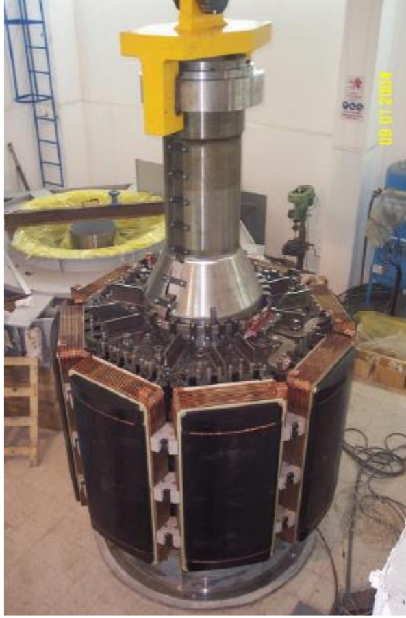
Bir senkron generatörün rotoru
