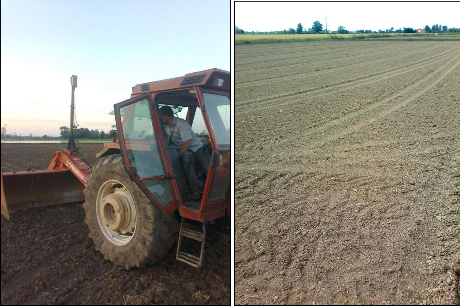
Şekil 1. Lazerli tesviye cihazı ve tesviyesi yapılmış arazi
