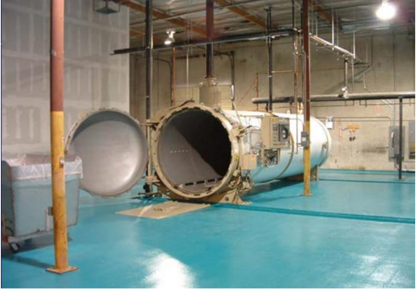
Şekil 5. Kapağı Açık Buharlı Otoklav
