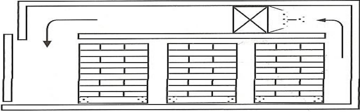
Yatay hava akışlı kesik çalışan kerevetli bir tünel dondurucu
