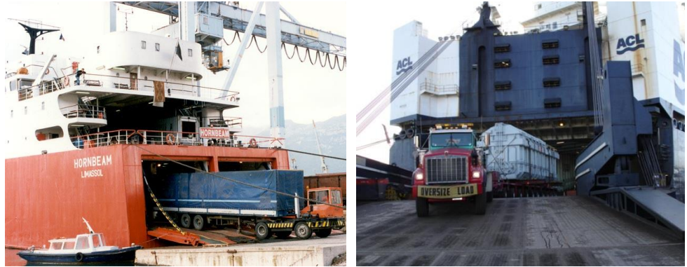
Şekil 8.2. RO-RO Gemilerinin Boşaltılması
