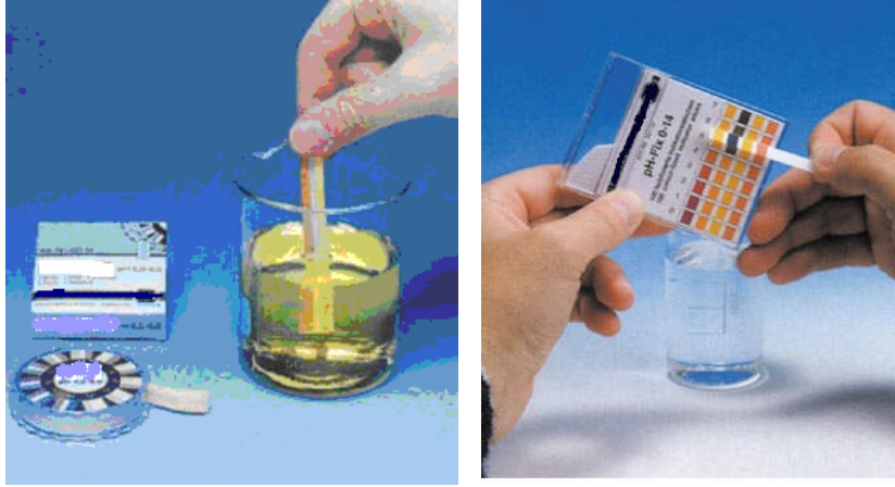
Resim 1. 2. Besiyeri pH'ının pH kâğıtları ile ölçülmesi
