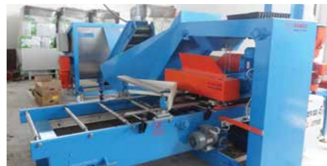
Şekil 4. Hazır Fide Yetiştiriciliğinde Kullanılan Özel Tohum Ekim Makinası
