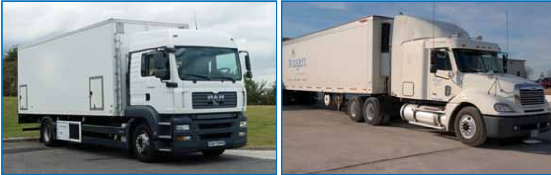
Şekil 3: Ortam kontrollü civciv nakil araçları
