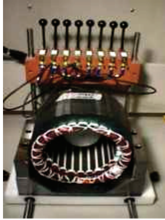
Resim 22.1 Stator
