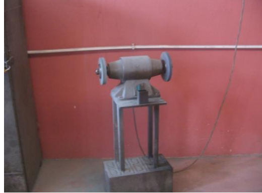
Koruyucuları olmayan zımpara taşı
