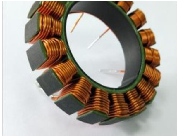
Şekil 5. Stator ve Stator Sargıları
