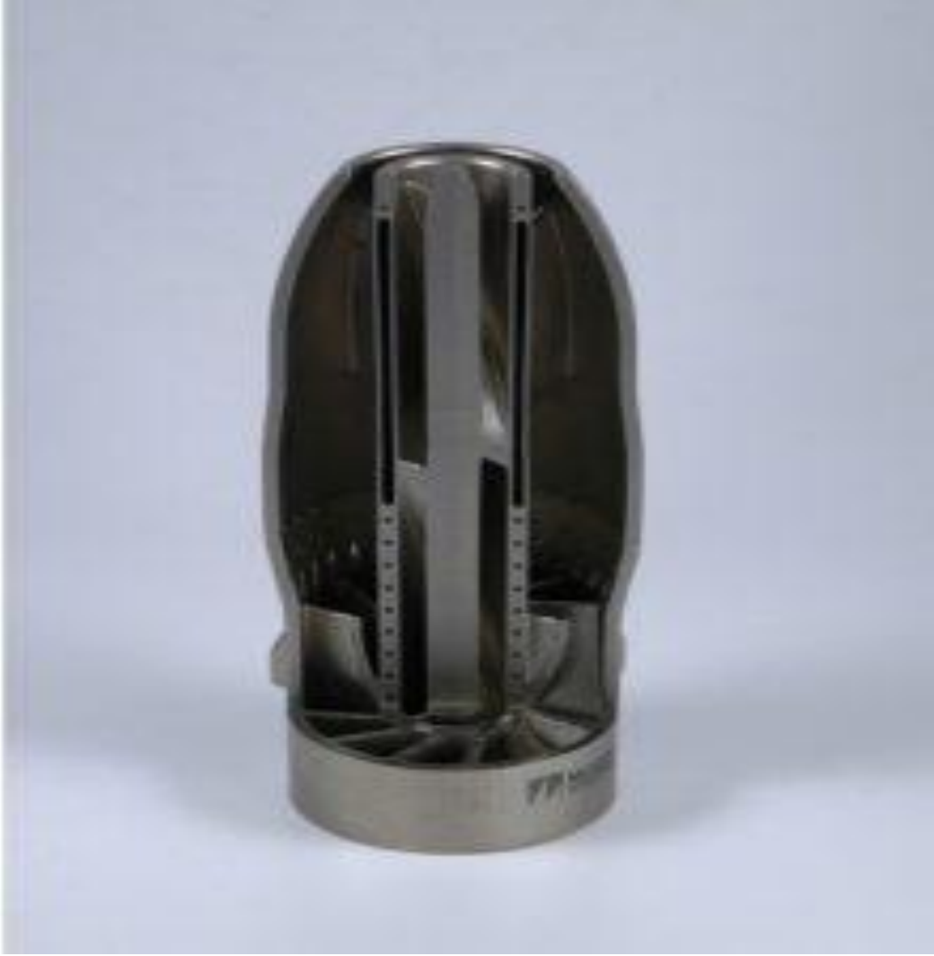
Lazer Işınli Ergitme ile üretilmiş karmaşık Yakıt Enjeksiyon Döndürücü
