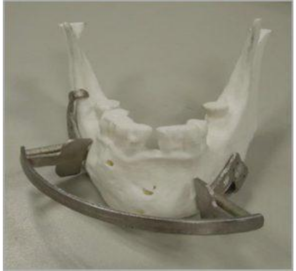
► Lazer Işınli Ergitme ile üretilmiş 316L cerrahi kılavuz
