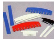
Poliakrilamid jel için kullanılan taraklar ve ayraçlar (spacer'lar)
