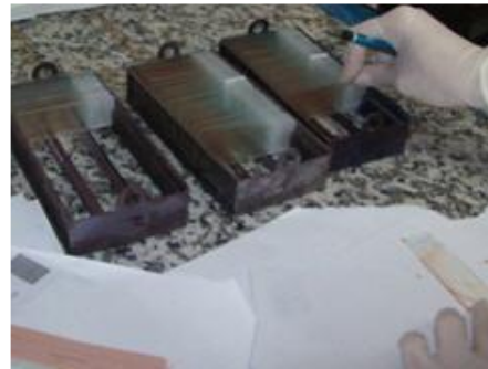
Lamların lam taşıma sepetine dizilmesi
