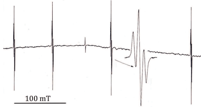
Şekil 1.17: \text{KH}_2\text{AsO}_4 tek kristalinin gama radyasyonuna maruz bırakılması sonunda oluşan tetrahedral yapıdaki \text{AsO}_4^{4-} radikalının bir yönelimdeki EPR spektrumu. farklı iki yerde yerleşen radikaller site yarılmaları nedeniyle bazı çizgileri ikiye yarmakta (daha sonra tartışılacak) ve tetrahedral yapıda As atomuna bağlı hidrojenlerden ikisi yakın, diğer ikisi uzaktır; iki yakın hidrojen her bir çizgiyi çok küçük değerlerde tekrar üçe yarmaktadır. Uzak hidrojenlerin yarılmaları çok küçük olduğundan çizgilerin iki yanındaki zayıf uydu çizgileri oluşturmaktadır, Kesim ??.
