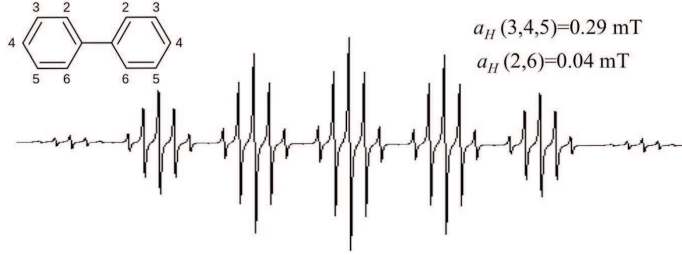
Şekil 1.13: Yüksek vakum altında indirgeme reaksiyonu ile elde edilen bifenil aniyon radikalının EPR spektrumu.
