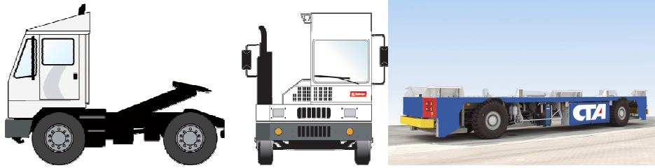
Şekil 23.: Terminal Traktörleri ve Şasiler
