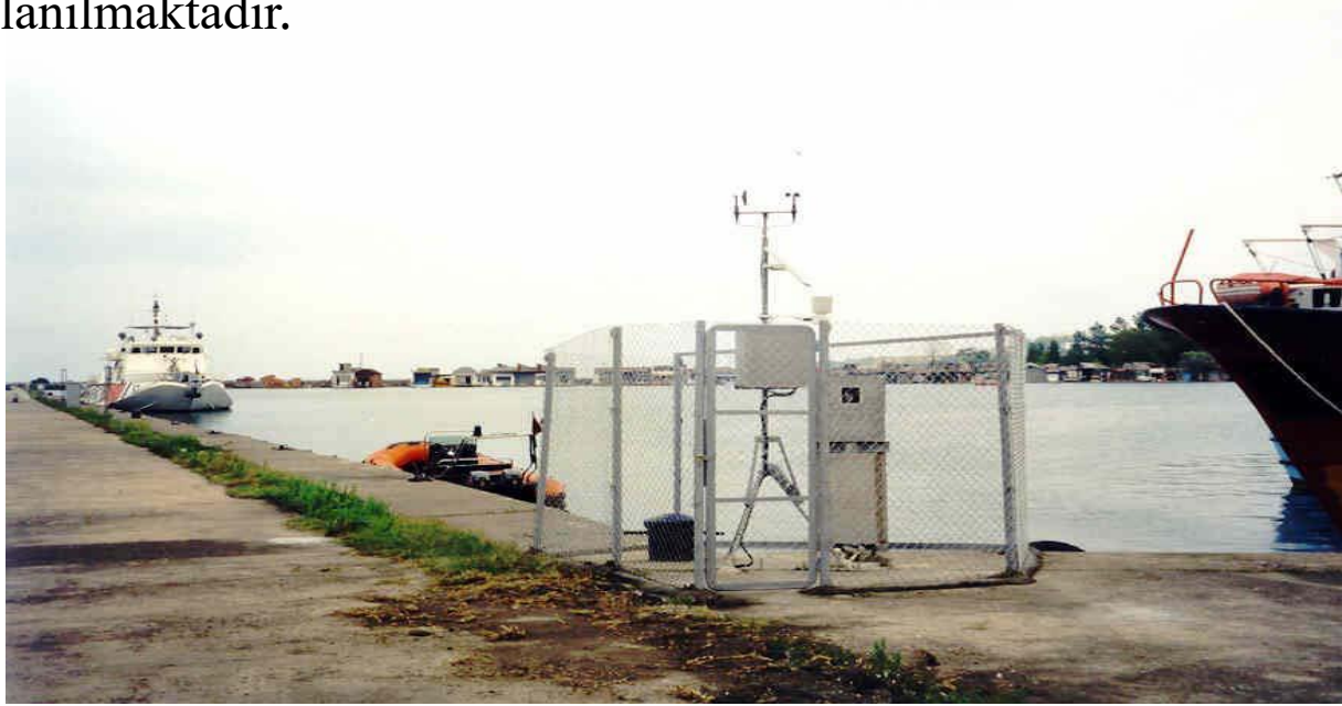
Trabzon-II sayısal ve otomatik mareograf istasyonundaki deniz seviyesi ölçme aleti (Yildiz et. al (2003).
