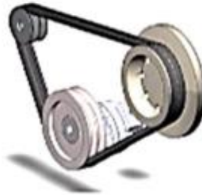
Kayış ve kasnak mekanizmaları
