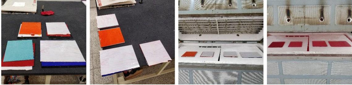
Görsel 3.9. Tasarıma göre renkleri seçilen plaka camlar istenilen ölçülerde kesilir, temizlenir ve füzyon fırınına yerleştirilir. En yüksek sıcaklıkta camlar kontrol edilir (Serkan Özer fotoğraf arşivi)
