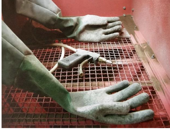
Görsel 2.51. Kumlama kabini içerisinden görüntü; eldiven ve kumlama tabancası (Schmuck, 2009, s. 86)
