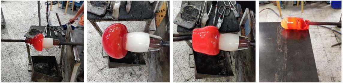
Görsel 3.5. Beyaz camla yeşil cam uç noktalarından birbirine yapıştırılır ve zıt renkli cam pipodan koparılarak beyaz cam üzerine ahşap boğma maşasıyla ve de çelik masa vasıtasıyla giydirilir
