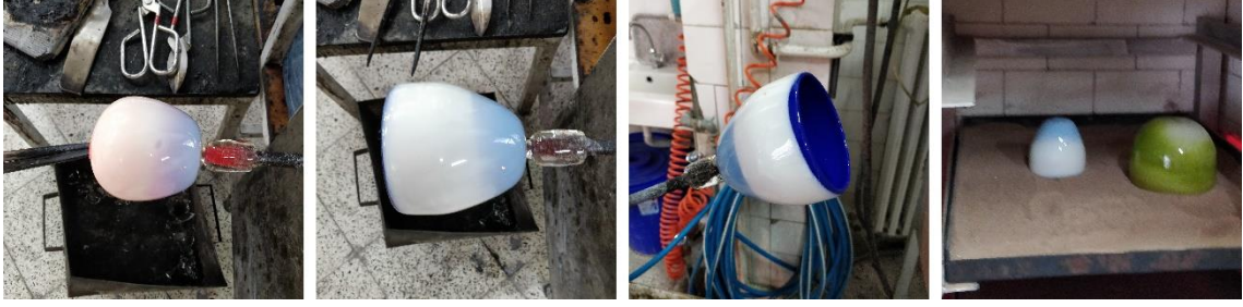
Görsel 3.8. Noble ucuna alınan camın ağız kısmı düzeltilerek, istenilen form şekillendirilir ve homojen olarak soğuması için tavlama fırınına yerleştirilir (Serkan Özer fotoğraf arşivi)
