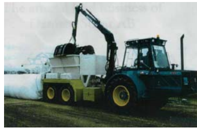
Fotoğraf 10. Vakum (Sosis)silonun doldurulması
