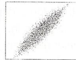
Şekil 59 Yarıkli tip memelerden eliptik izli yelpaze hüzmeye oluşması (110, 114)
