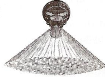
Şekil 64 Ön orifisli yelpaze hüzmeli meme (110)
